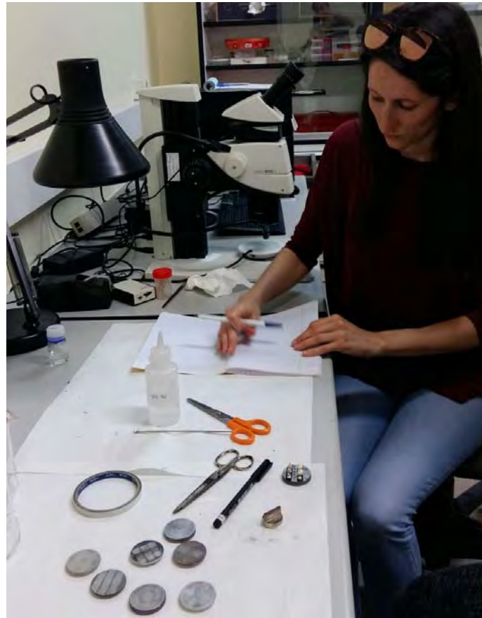
Figura 17. Preparando las muestras en el portamuestras de aluminio para su visualización en el microscopio electrónico de barrido.
