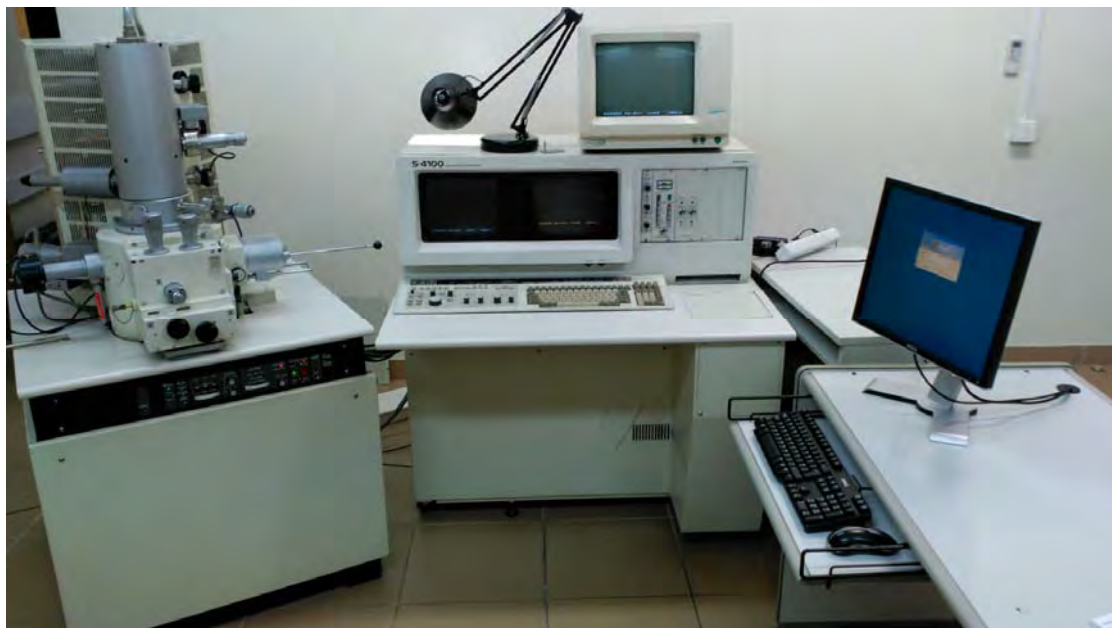
Figura 16. Microscopio electrónico de barrido S-4100 (HITACHI) del SCSIE
