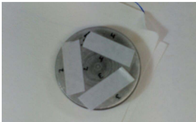
Figura 18. Cinta conductora de doble cara de carbono donde se adhirieron las muestras.
